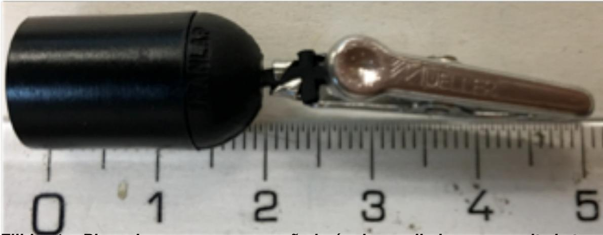
**Figura 1a:** Pinza de agarre con pequeño imán de neodimio que permite la tracción de los
